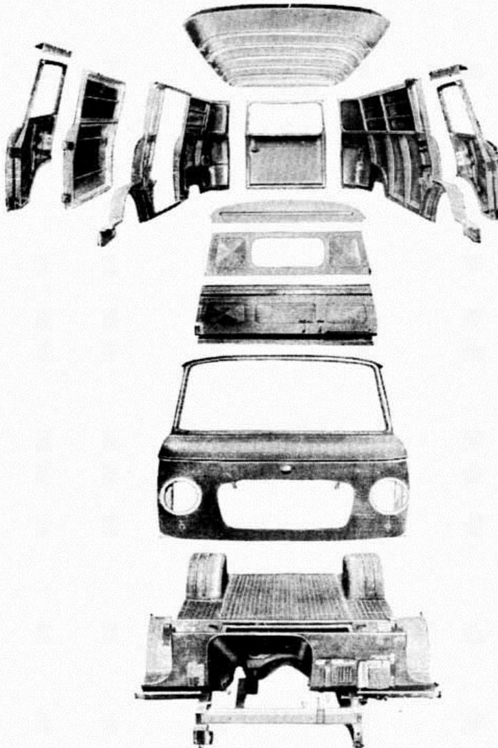
Bild 3. Darstellung der den Wagenkörper ergebenden Sektionen
