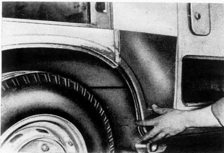
Bild 18. Reparatur am Seitenmittelstück, Außenblech
